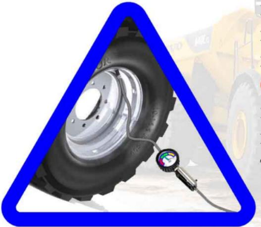
Поддержание правильного давления в шине увеличивает срок службы шин и предотвращает неравномерный износ шин и вероятность “взрыва” шин.
