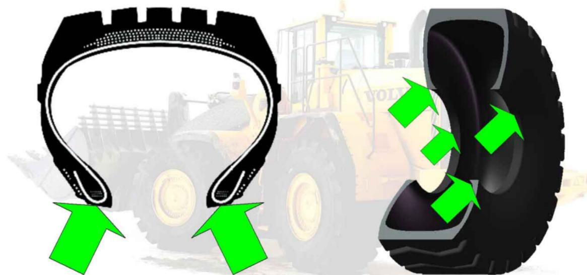
Будьте осторожны при транспортировке шины. Не допускайте повреждения шины и особенно бортов шины.
